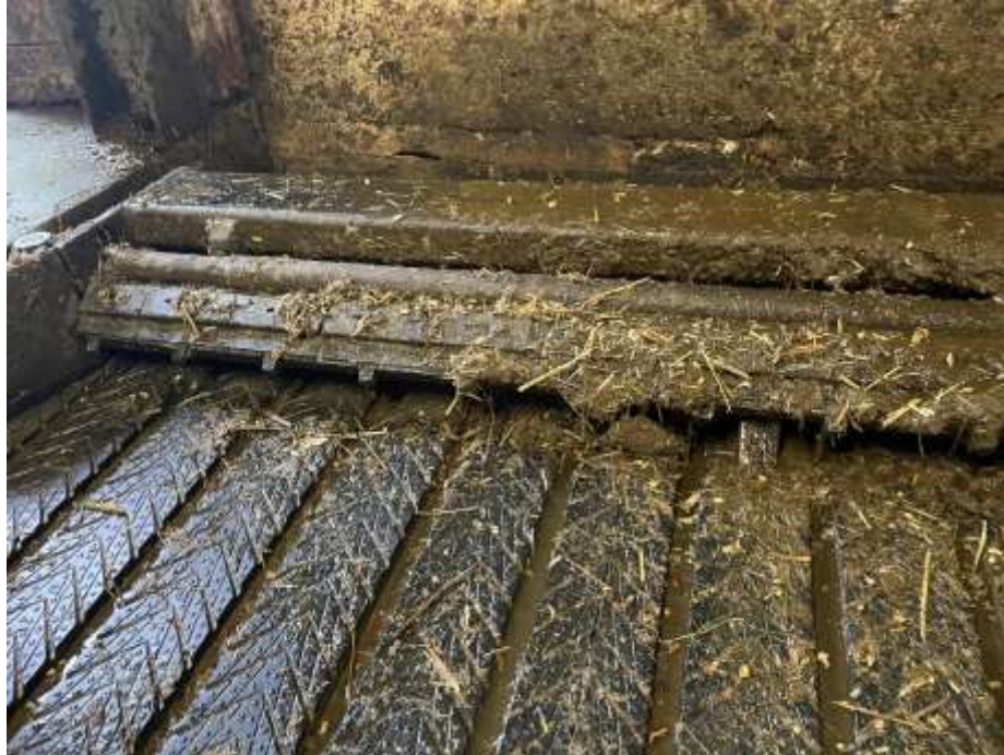
Tous des racleurs d'évacuation avec « peigne » de nettoyage des rainures
