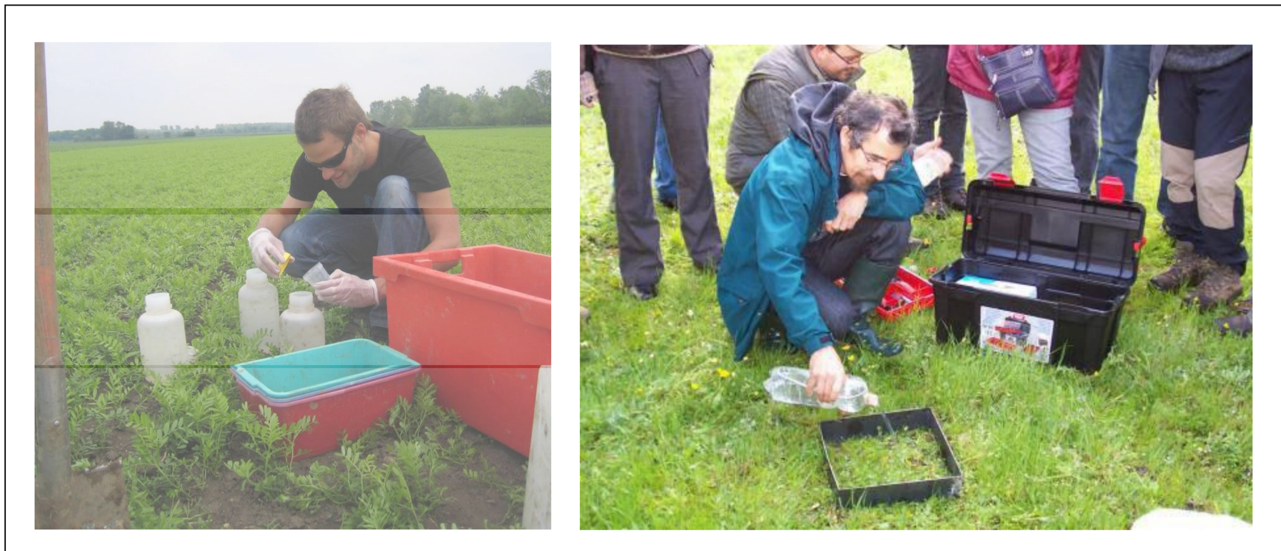
Abb. 1: Austreiben der Regenwürmer: Herstellen der AITC-Lösung und Aufbringen auf den Boden
