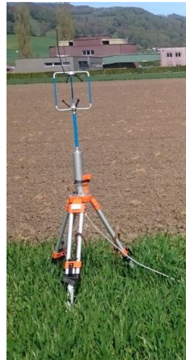
Sonic anemometer Wetterstation 3D Messung der Luftbewegung
