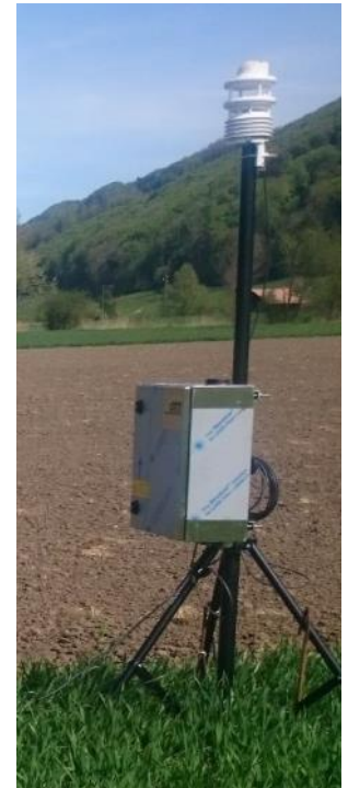
Sonic anemometer Wetterstation 3D Messung der Luftbewegung
