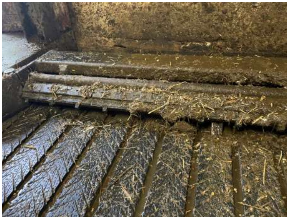
Alle Entmistungsschieber mit Kammräumleiste
