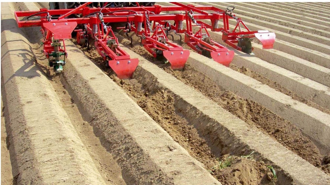
Abbildung 2.6: Dammformung beim Kartoffelanbau. Diese als Querdammhäufler bezeichnete Maschine bildet in den Rinnen zusätzlich kleine Querdämme, welche den Oberflächenabfluss und damit das Erosionsrisiko reduzieren (Foto: LaFranceAgricole)
