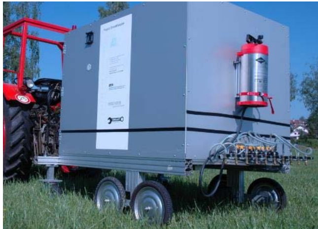
SmartWeeder Prototyp für Blacken- bekämpfung von Agroscope & ZHAW
