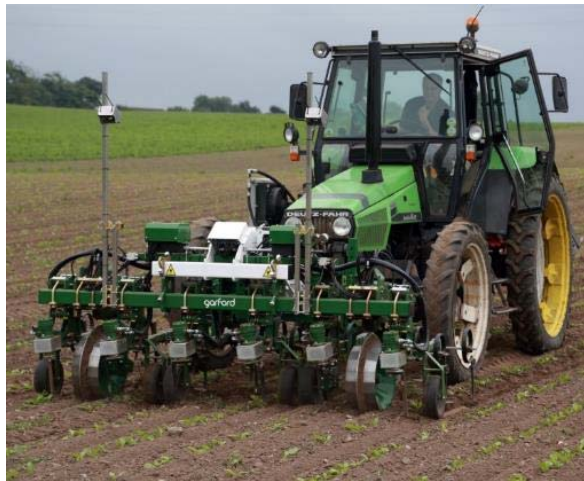
SmartWeeder Prototyp für Blacken- bekämpfung von Agroscope & ZHAW
