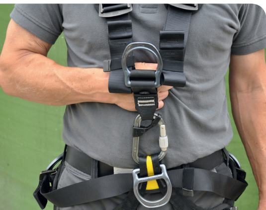
Mit der Faust kann kontrolliert werden, ob der Auffanggurt genügend angezogen wurde.
