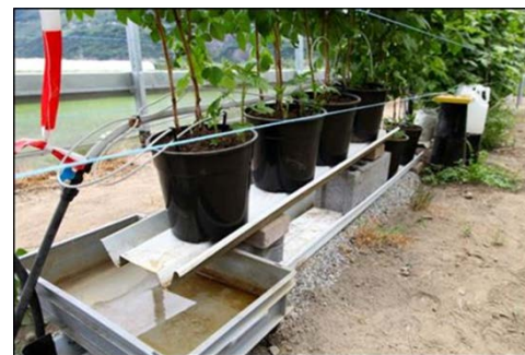
Abb. 9. Messung des Drainagevolumens.
