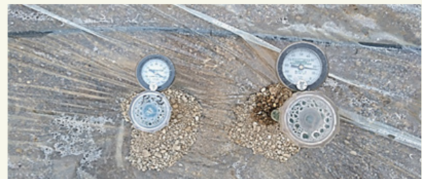
Fig. 1: Tensiometri per misurare l'umidità del terreno durante solarizzazione. Quello di sinistra è posto a 15 cm di profondità, e quello di destra a 35 cm di profondità.
