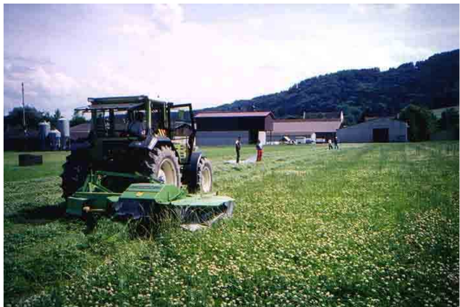
Fig. 3: Trattore con falciatrice laterale durante lo sfalcio del campo di trifoglio bianco
