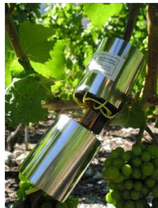
Mesure des flux de sève brute dans les rameaux (transpiration)
