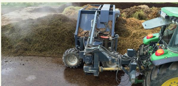
Fig. 1: Homogénéisation de compost thermophile à l'aide d'un retourneur de compost
