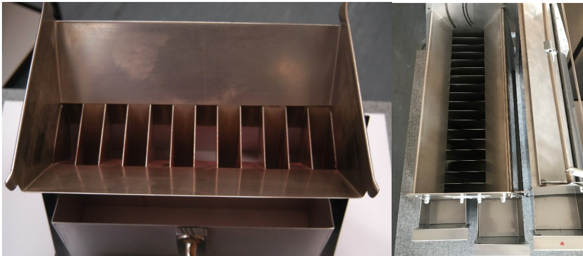
Fig. 5: Construction d'un diviseur à riffles
