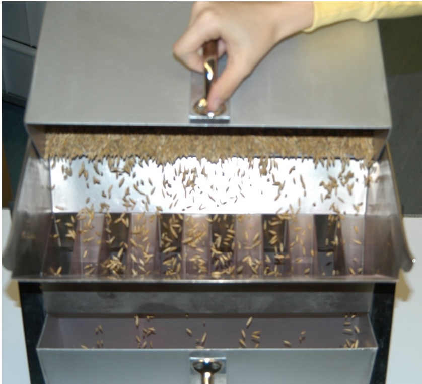
Fig. 6: Division d'un échantillon global avec le diviseur à riffles - vider le contenu du récipient en un mouvement, dont l'axe est parallèle à la trémie de réception.
