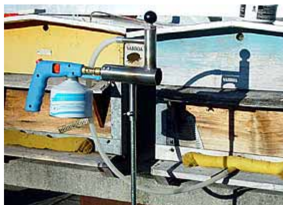
Photo 5: Evaporateur à gaz „Krüso“
