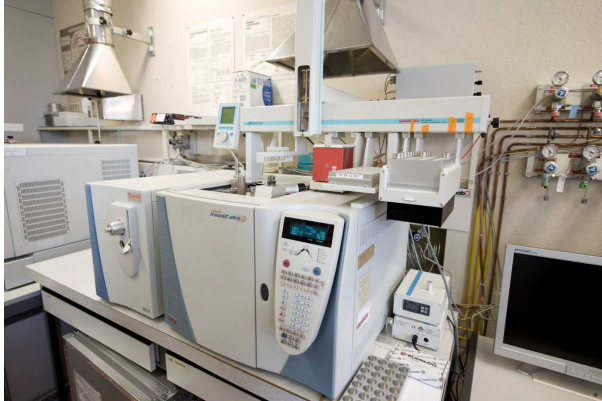
Thermo Scientific DSQ II Single Quadrupole GC-MS/PFPD und wahlweise FID oder ECD
