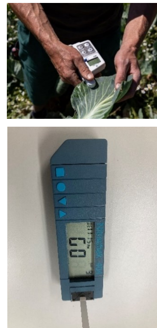
Abbildung 4: Eingesetzte Tools zur N- Bedarfsanalyse im Projekt Ressourceneffiziente N-Düngung im Gemüsebau.
