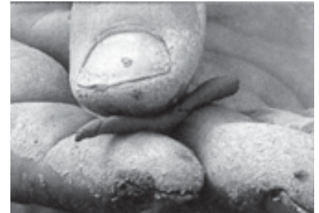
Abb. 4: Mittels der Fingerprobe können direkt im Feld Rückschlüsse auf die Körnung bzw. die Bodenart und die Bodenfeuchtigkeit gezogen werden.
