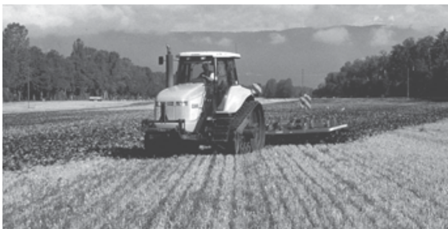
Abb. 7 + 8: Reifenfahrwerk mit vergleichsweise kleiner Kontaktfläche (Abb.7, Foto Case) und Raupenfahrwerk mit grosser Kontaktfläche (Abb.8, Foto P. Trachsel). Die Motorleistungen dieser Traktoren liegen in der gleichen Grössenordnung, das Gesamtgewicht des Raupentraktors ist beträchtlich höher.
