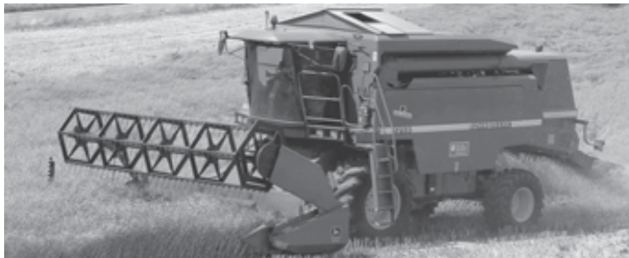
Abb. 9: Mähdrescher mit 7630 kg Radlast. Als Anwendungsbeispiel stellt sich die Frage, ob mit vollem Korntank allenfalls eine Schadverdichtungsgefahr auftreten kann. (Foto Matra)
