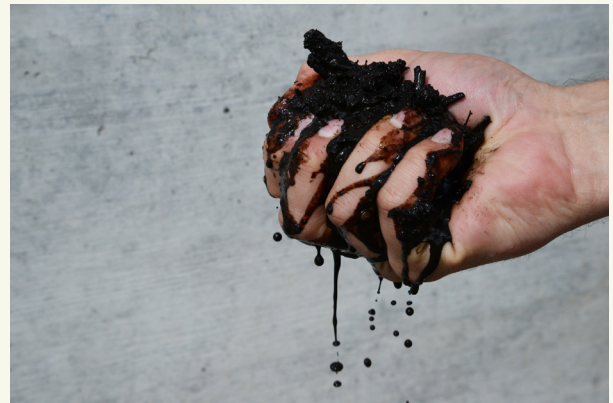
Abb. 4: Fausttest: Der Kompost ist zu nass.
