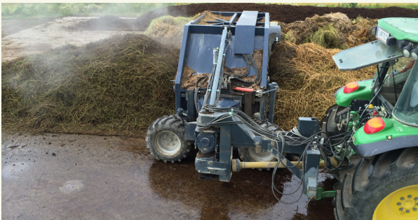
Abb. 1: Abmischen der Ausgangsstoffe für Heißrottekompostierung mit einem Kompostwender
