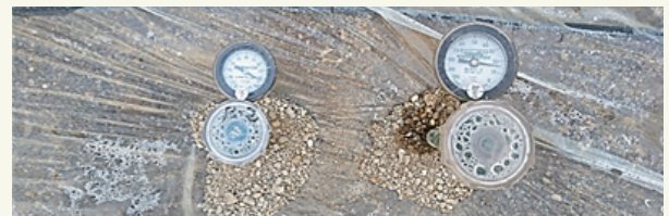
Abb. 1: Tensiometer zur Messung der Bodenfeuchtigkeit während der Solarisation. Das linke Tensiometer misst in 15 cm Tiefe und das rechte in 35 cm Tiefe.
