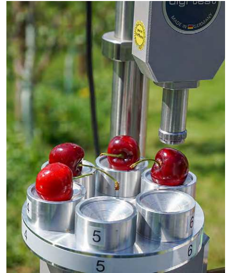
Ein Prototyp der Firma Tobi Seebst misst die Festigkeit von Kirschen.
