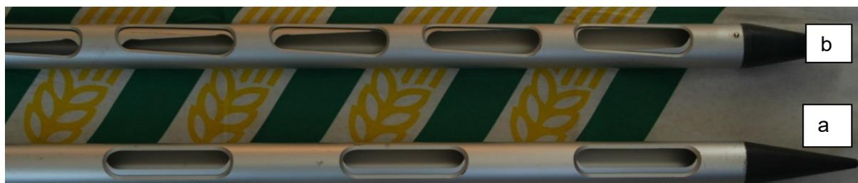
**Abb. 4: Gekammerter Probenspeer (a); Probenspeer mit von unten versetzt öffnenden Öffnungen (b); für Samen, welche kleiner als die von Weizen sind.**
