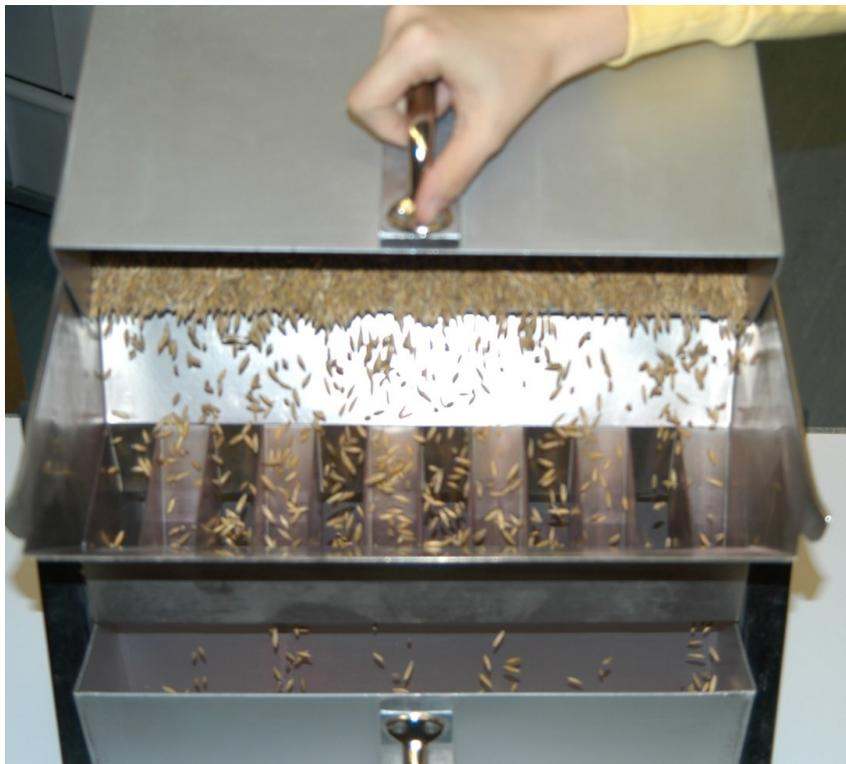
**Abb. 6: Aufteilung von Mischproben mit dem Riffelprobenteiler - Saatgut in einem Zug über die Kante hinein kippen**
