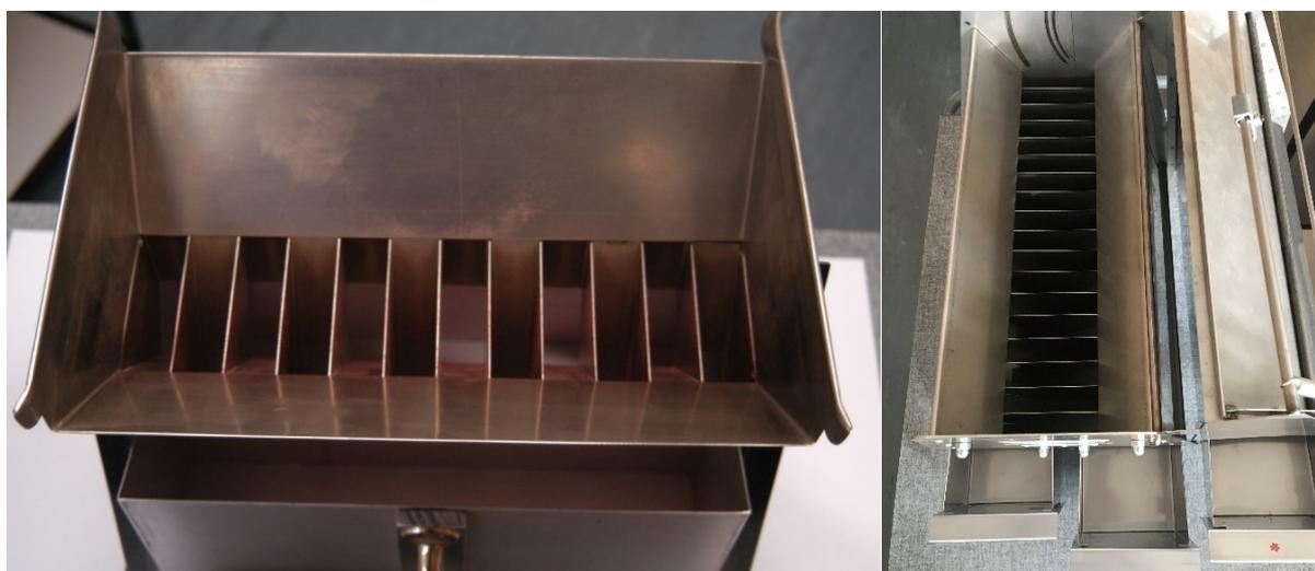
Abb. 5: Aufbau eines Riffelprobenteilers für die Aufteilung der Mischprobe
