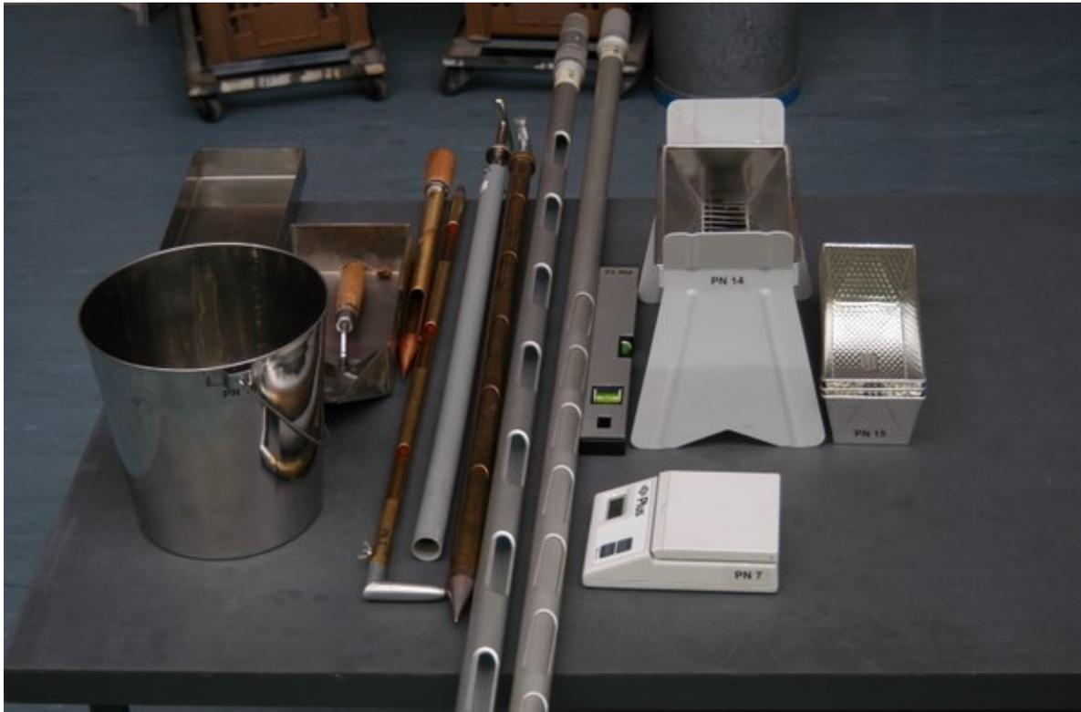
Abb. 2: Geräte für die manuelle Probenahme von Saatgut
