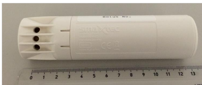
pH-Bolus zur Messung des pH im Netzmagen.
