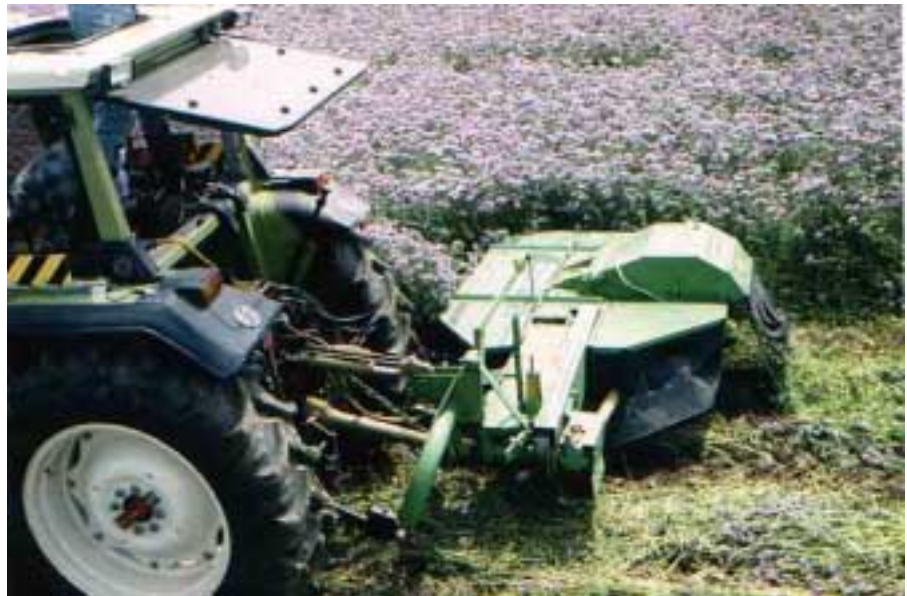
Abb. 8. Traktor mit seitlich angebautem Mähwerk beim Mähen im Phaceliafeld.
