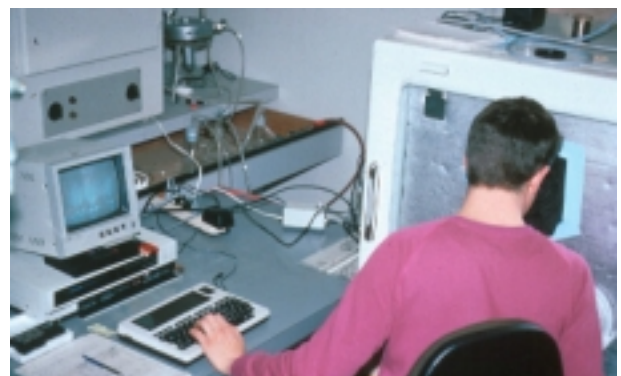
Abb. 3b. Eine Zelle wird unter einer Lupe betrachtet, die mit einer Videokamera ausgestattet ist. Die Beobachtungen erfolgen entweder direkt durch das Binokular oder indirekt auf dem Videomonitor. (Foto: J. Hättenschwiler)
