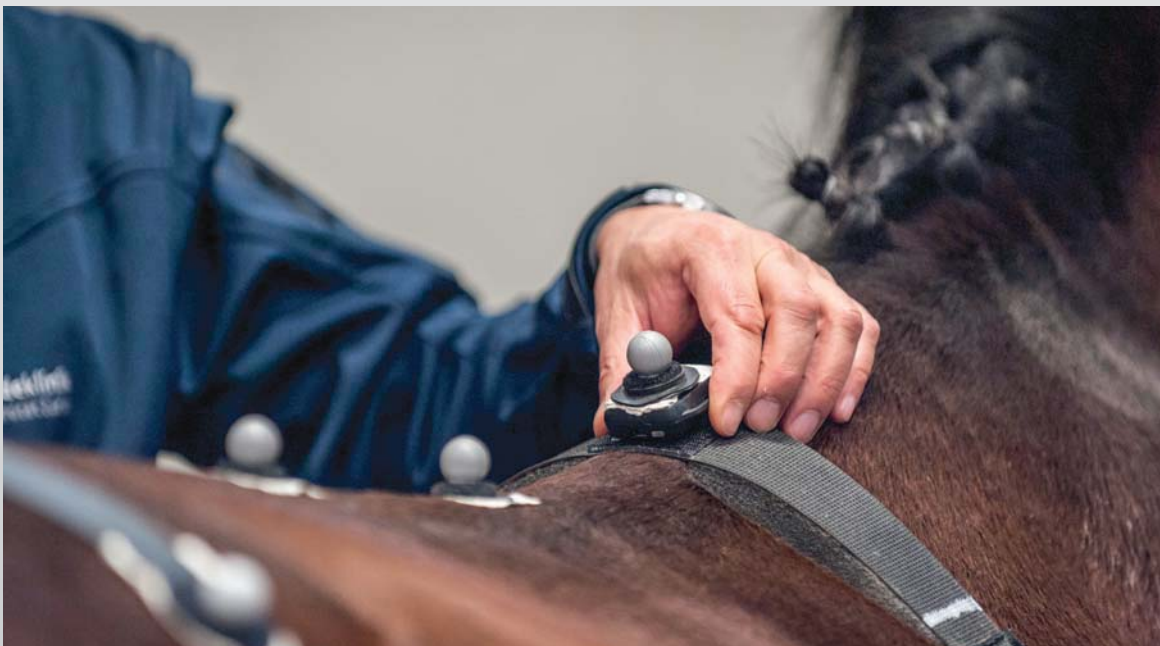
Fig. 2: Des marqueurs réfléchissants ont été placés sur certains capteurs IMU pour vérifier la concordance entre le système de caméras et le système des IMU.
