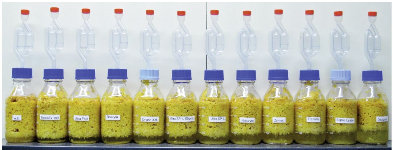
Die zwölf Ansätze der Gärversuche im Labormasstab.
