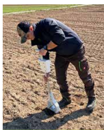
Mise en place de l'essai de fertilisation azotée optimisée dans les cultures de céleri. Le Nmin du sol est analysé de deux manières: sur des échantillons prélevés au champ, ainsi qu'au moyen d'une bêche Stenon (en bas à gauche).
