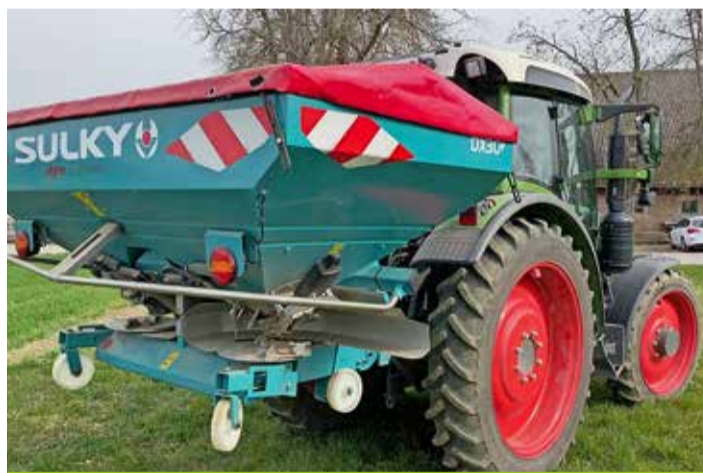
Pour appliquer la méthode VR, le semoir à engrais doit être équipé d'une prise isobus.
