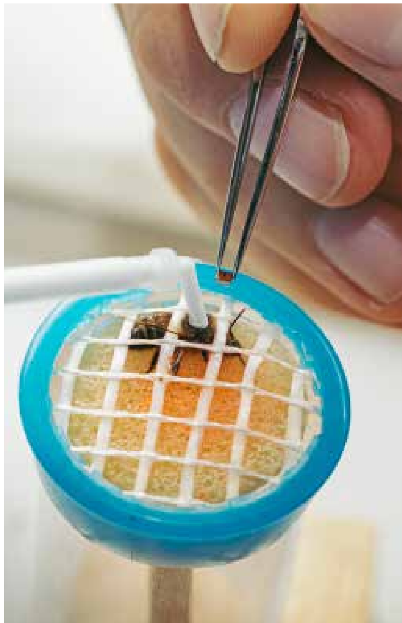
Mit Fingerspitzengefühl und Zahnzement: Wissenschaftler statten im Labor von Agroscope in Liebefeld Bienen mit RFID-Chips aus
