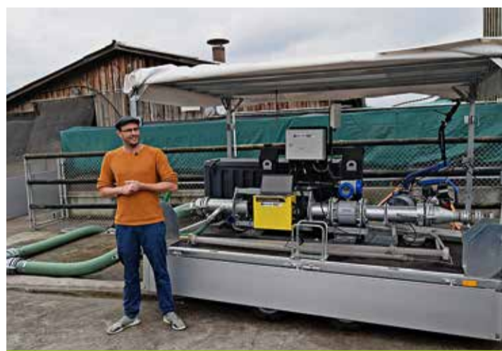
Grâce à cette installation mobile dotée d'un capteur NIRS, Thomas Steinsberger mesure précisément les éléments nutritifs présents dans les fosses à lisier.
