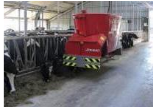
mobile Mischbehälter (Schienengebunden, Induktionsschleifen, Distanzsensoren)
