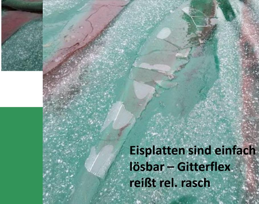
Eisplatten sind einfach lösbar – Gitterflex reißt rel. rasch
