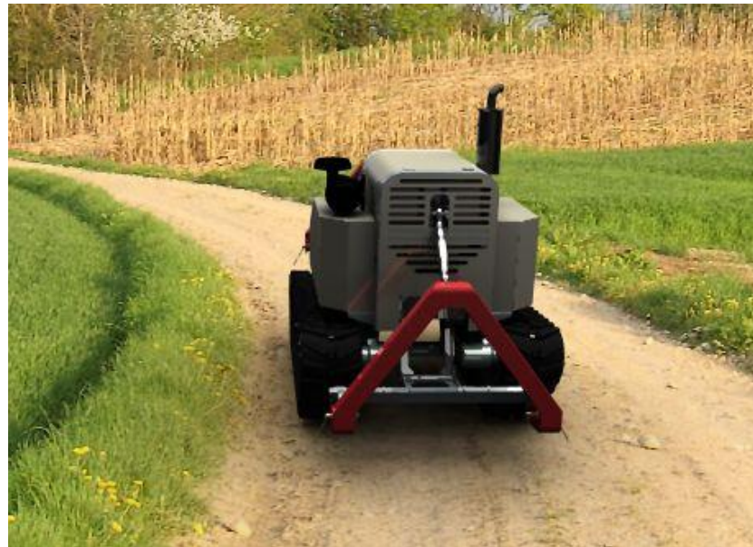
CAD-Modell eines möglichen teilautonomen Feldfahrzeuges (unveröffentlichte Bachelorarbeit BFH-TI)
