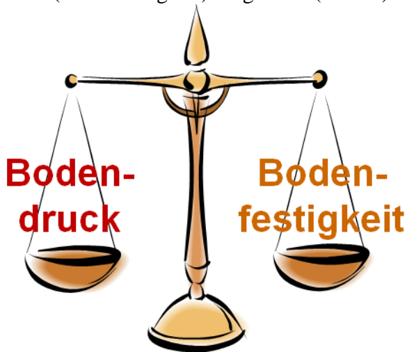
Abbildung 1: Das Grundprinzip von Terranimo ® , der Vergleich von Bodendruck und Bodenfestigkeit.
