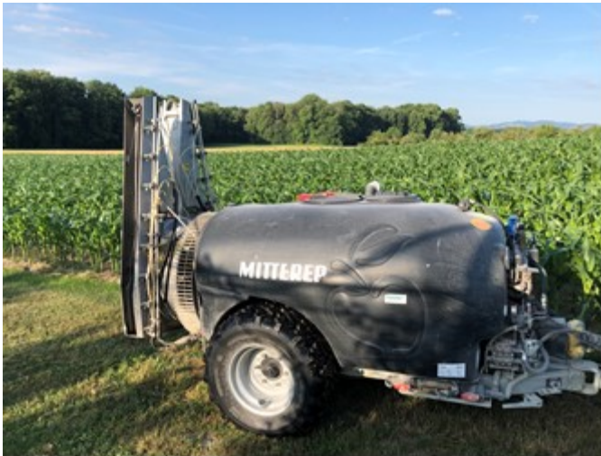
Feldspritze nach der Applikation von Pflanzenschutzmitteln; Auf der Oberfläche sind Restmengen an PSM ersichtlich, die bei unsachgemässer Handhabung ins Gewässer gelangen könnten. Foto: R. Leumann
