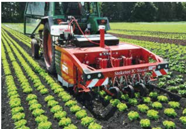
Figure 1 | Pulvérisation ponctuelle sur laitue feuille de chêne verte à l'aide du prototype (Agroscope).
