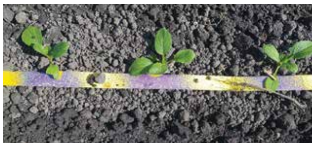
Figure 2 | Vérification de la qualité de pulvérisation sur pak choi à l'aide de papier hydrosensible. Le diamètre de la plante est comparé à la longueur du traitement par plante pour définir la justesse des volumes épandus. L'espace entre plantes n'est pas traité (Agroscope).
