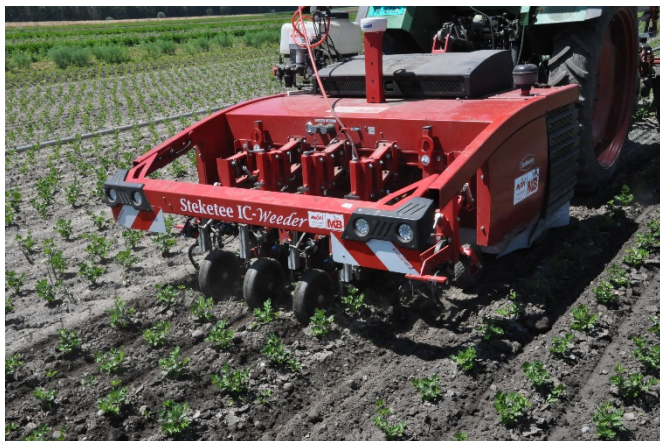
Abbildung 2: Testfahrt mit dem Pflanzenschutzroboter in gepflanztem Sellerie.
