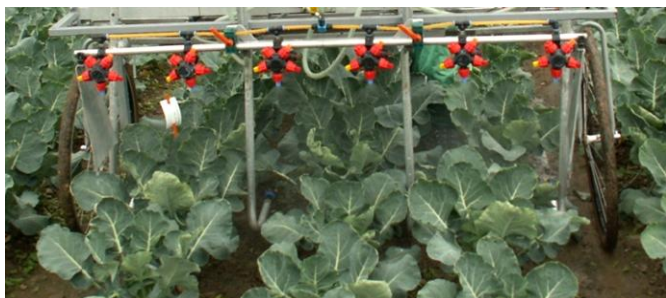
Abb. 4: Kombinierte Anwendung von Feldbalken und Spritzbeinen (Droplegs) an Kleinparzellenspritze in Broccoli.
