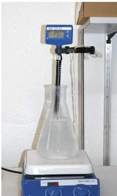
zugegeben (Konzentrationen: 2.5, 5 und 10%). Unter ständigem Rühren (500 Umdrehungen/min) wurde in allen zwölf Verfahren die Zeit bis zum vollständigen Auflösen des LMA ermittelt (Abb. 2, Tab.). Abbildung 1 zeigt das Lösungsverhalten von LMA in Abhängigkeit von den vier Wassertemperaturen respektive den drei Konzentrationen. Fazit: Je höher die Wassertemperatur und je geringer die Konzentration, desto besser löst sich LMA auf.
