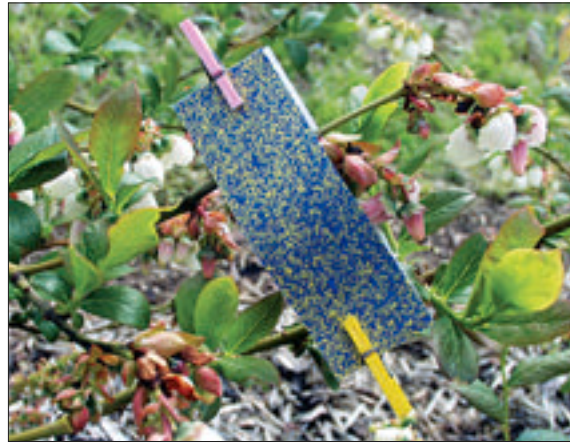
Abb. 3: Mit gelbem, wassersensitivem Papier, das sich beim Besprühen blau verfärbt, wurde überprüft, dass Blattoberseiten und Blattunterseiten, Blüten und Triebe möglichst gleichmässig und ohne Abtropfverluste besprüht wurden.
