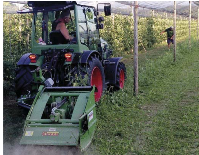
Abb. 3: Zwei Monate nach der Aussaat wurden die blühenden Senfpflanzen mit einem Schlegelmulcher zerkleinert, von der Fahrgasse in den Baumstreifen verschoben und mit einer Spatenmaschine eingearbeitet.
