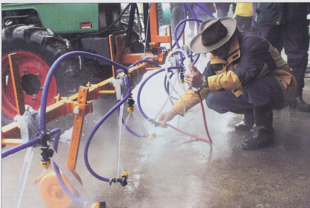
Abb. 5: Messen des Durchflusses der Düsen mit einem Durchflussmesser an einem Erdbeerspritzbalken als Teil der Arbeiten zur Kalibrierung dieses Sprühgeräts.
