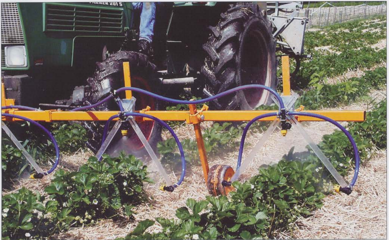
Abb. 7: Teilansicht eines Erdbeerspritzbalkens für die angepasste Behandlung von sechs Reihen. Pro Reihe sind oben eine und seitlich je zwei Doppelfachstrahldüsen montiert, deren Sprühflächen nicht rechtwinklig, sondern leicht angewinkelt auf die Pflanzreihe gerichtet sind. Die seitlichen Düsen sind leicht von unten nach oben ausgerichtet und werden so tief wie möglich an den Pflanzreihen entlang geführt.
