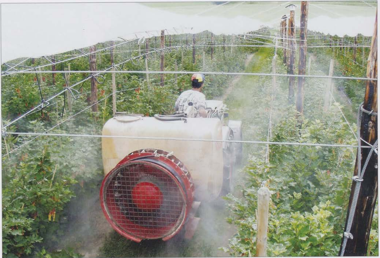
Abb. 10: Beim Einsatz von Axialsprühgeräten in Johannisbeeranlagen können nicht einfach die Geräteeinstellungen aus einer Kernobstspindelanlage übernommen werden. Die Brühmengen sind an die Hecke und deren Wachstumsstadien (siehe Tab. 4) anzupassen. Insbesondere die Luftleistung muss mässig gewählt werden, damit eine gute Anlagerung der Sprühtröpfchen an die zu schützenden Pflanzenteile erzielt wird.
