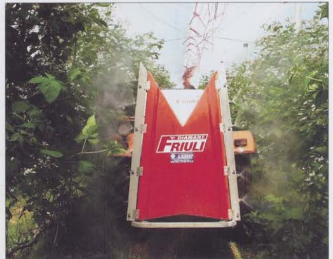
Abb. 9: Gebläsespritze im Einsatz in einer Brombeeranlage. Die Düsen und der Luftstrom sind nicht im rechten Winkel zu den Pflanzreihen, sondern leicht nach hinten gerichtet, was ein besseres Eindringen der Spühtropfchen ins Blätterwerk erlaubt. Die Luftleistung ist bei 3 m Reihenabstand massvoll zu halten: Die Blätter sollen sich im Luftstrom bewegen, durch diesen aber nicht abgebrochen oder ganz nach oben oder unten umgeklappt werden.
