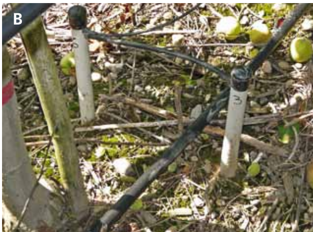
Figure 6 | Sondes utilisées en arboriculture. Les tensiomètres (A) sont de moins en moins utilisés car ils fonctionnent dans une faible plage de mesure (0–80 cbars), demandent beaucoup d'entretien et ne permettent pas d'enregistrer les données. Les sondes Watermark® (B) indiquent l'humidité du sol jusqu'à 200 cbars, peuvent rester en place plusieurs années sans entretien et, reliées à un datalogger (C), permettent d'enregistrer à fréquence élevée (plusieurs fois par jour si nécessaire) les variations d'humidité du sol. Le transfert des données sur PC est simple et rapide.
