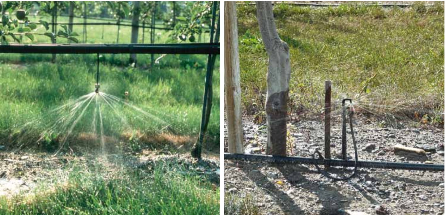
Figure 1 | A gauche , microjet suspendu utilisé dans les cultures denses; à droite , microjet couvrant une zone plus large pour les cultures à plus faible densité de plantation.
