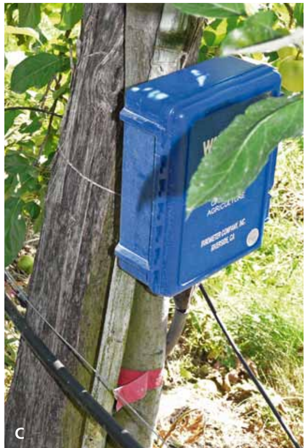
Figure 6 | Sondes utilisées en arboriculture. Les tensiomètres (A) sont de moins en moins utilisés car ils fonctionnent dans une faible plage de mesure (0–80 cbars), demandent beaucoup d'entretien et ne permettent pas d'enregistrer les données. Les sondes Watermark® (B) indiquent l'humidité du sol jusqu'à 200 cbars, peuvent rester en place plusieurs années sans entretien et, reliées à un datalogger (C), permettent d'enregistrer à fréquence élevée (plusieurs fois par jour si nécessaire) les variations d'humidité du sol. Le transfert des données sur PC est simple et rapide.
