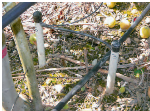
Abb. 6: Feuchtigkeitsfühler im Obstbau: Tensiometer (links), die an Bedeutung verlieren, da der Messbereich zwischen 0 und 80 cbar zu eng ist und Watermark® (rechts), die eine Saugspannung bis 200 cbar anzeigen und an Datenlogger angeschlossen werden können.
