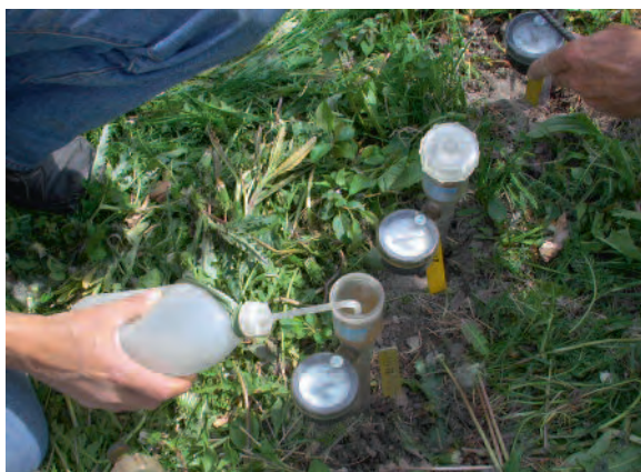
Abb. 6: Feuchtigkeitsfühler im Obstbau: Tensiometer (links), die an Bedeutung verlieren, da der Messbereich zwischen 0 und 80 cbar zu eng ist und Watermark® (rechts), die eine Saugspannung bis 200 cbar anzeigen und an Datenlogger angeschlossen werden können.
