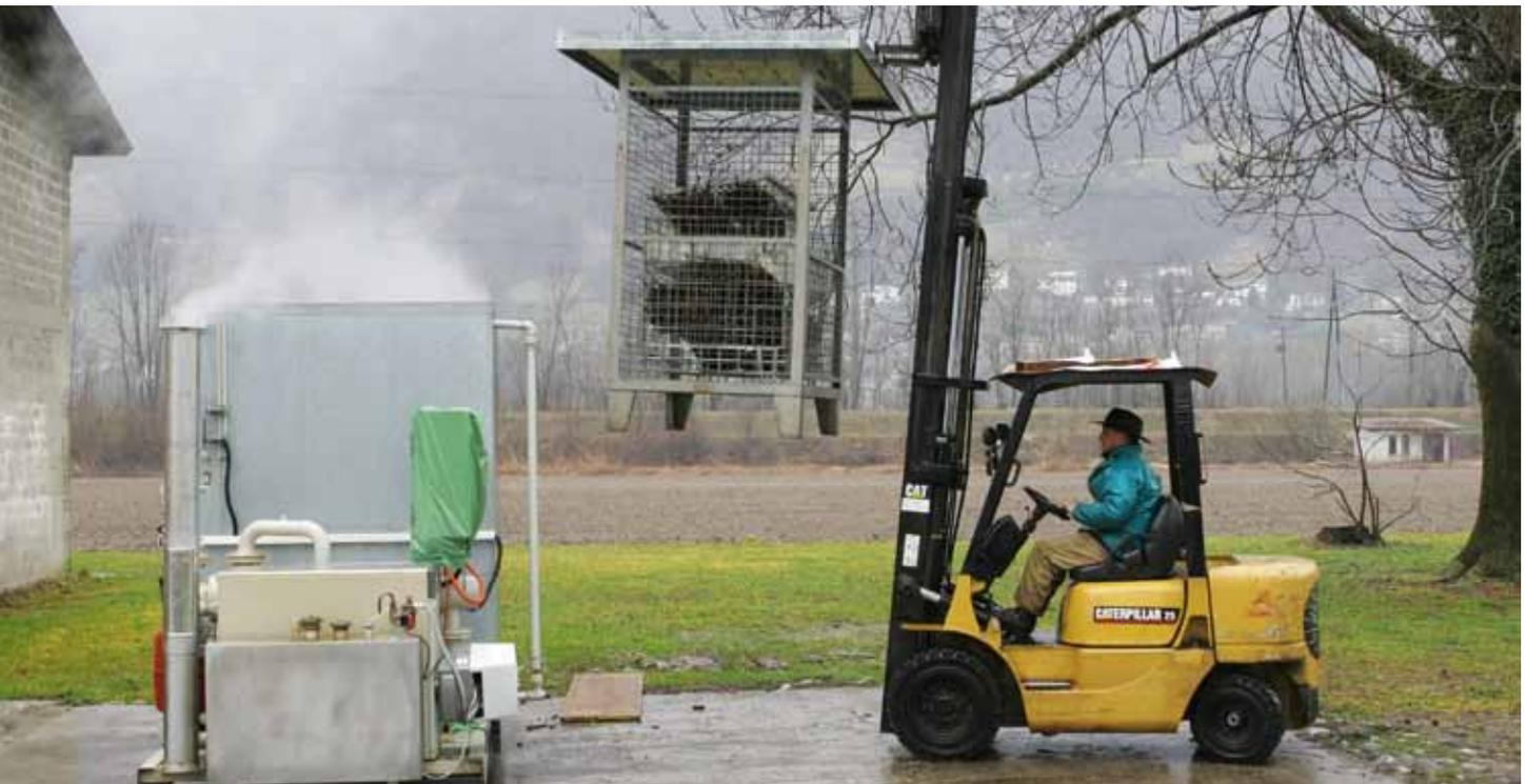
Figure 1 | Traitement du matériel à l'aide d'une unité de traitement à l'eau chaude de type RECS ([www.recs-fr.com](http://www.recs-fr.com)).
