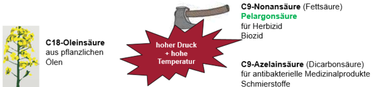
Abbildung 1: Vereinfachte schematische Darstellung der Gewinnung von Pelargonsäure (Quelle: Belchim.at)
