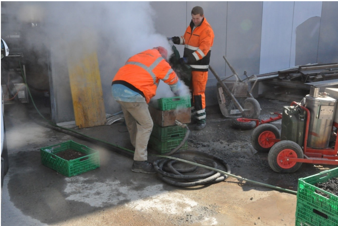
Bild 3: Die Erde wurde nach 15 Sekunden Dampfbehandlung jeweils umgeschüttet. Dies wurde pro Kiste fünfmal gemacht und entspricht etwa dem Durchlauf der Erde im geplanten Gerät.
