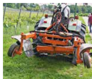
Désherbage à Rolofaca – une machine qui plie les herbes.
