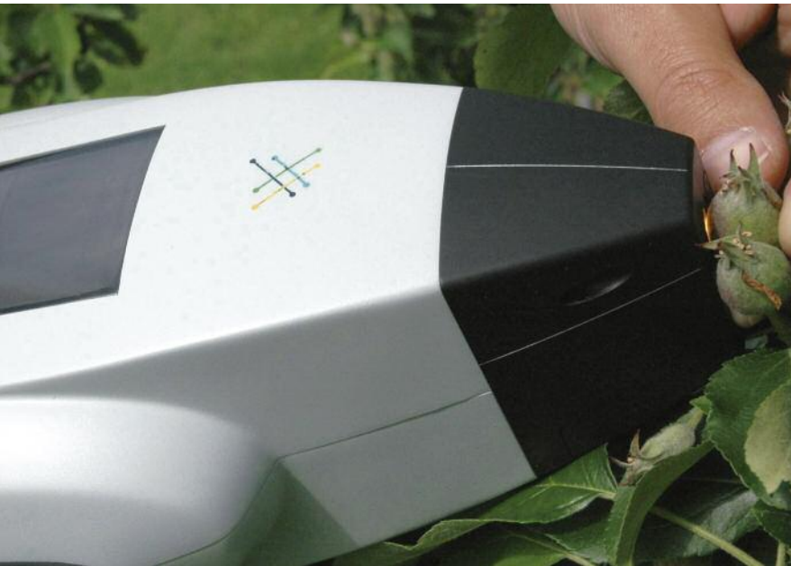
Abb. 5: NIRS-Gerät im Einsatz. In dieser Studie wurden die Früchte mit dem Reflexions-Spektrometer Phazir (PZ1018, Polychromix) gemessen. Dieses zeichnet NIRS-Spektren im Wellenlängenbereich von 930 bis 1800 nm auf.
